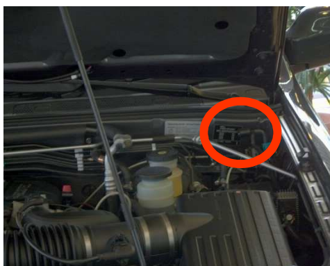
VIN PLATE LOCATION FRONTERA
